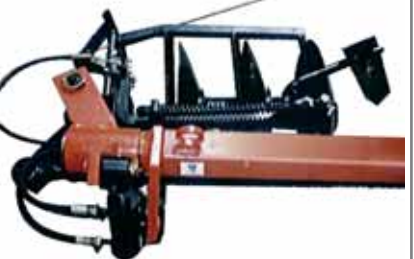
Paletta Puliscipianta Trees-Cleaning Blade Lame Essuie-Plante Zusatzmesser als Verlängerung zum Arbeiten bis nahe an den Stamm Equipo Limpieza Planta
